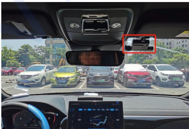
Устройство имеет встроенную GPS-антенну. Чтобы избежать помех, старайтесь не размещать его в затемнённых зонах в средней и верхней части лобового стекла. На следующем рисунке показан неправильный способ установки:
