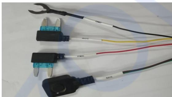
Красный провод питания (плюс) подключается к положительной клемме основного блока питания автомобиля.
